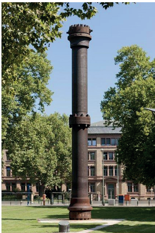
Abbildung 5. Photographie eines Ammoniaksynthesereaktors von 1925, jetzt ausgestellt vor dem BASF-Gesellschaftshaus.
